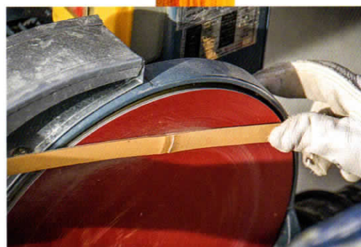
Bladknutarna slipas ned på ytsidan och insidan.
