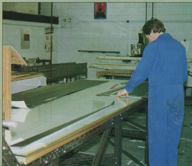
Duken skärs till, rullas omkring mandrelen och bakas i ugnen.
