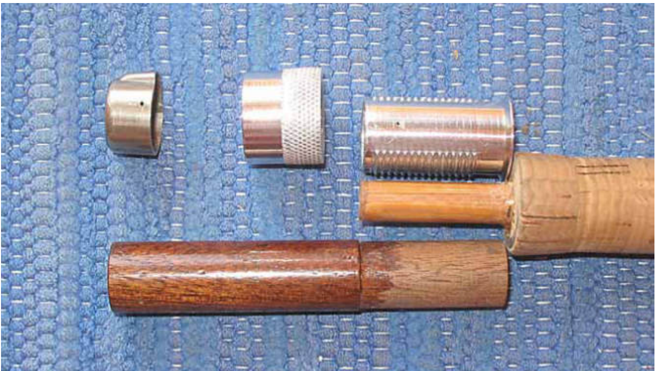
3. Nærbilde av snellefeste. "Pinholes" i ende "cap'en" og gjengedelen sees tydelig. Treinnlegget under metaldelen er uten lakk.
