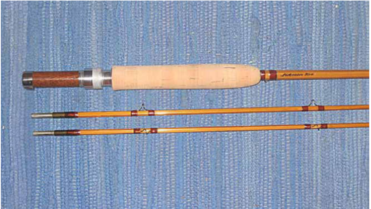
9. Ferdig stang med nytt korkhåndtak.
