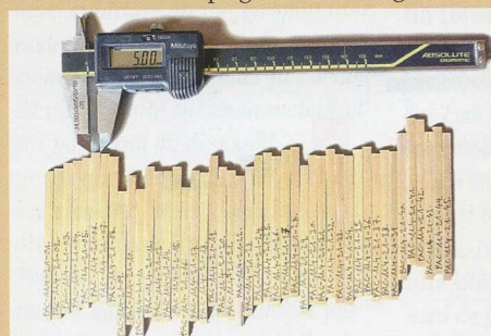
Handhyvlade Tonkinprover för trepunkts böjningstest, 3 mm tjocka, 5 mm breda, 80 mm långa. Före böjning mäts varje provs dimension och vikt individuellt.
