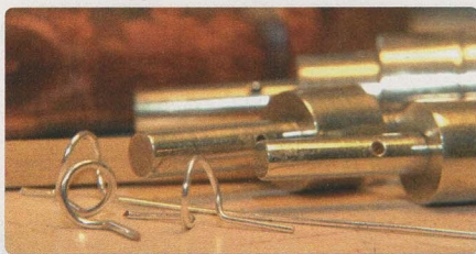
Specialværktøj til bukning af slangeringe laver man da selv.
